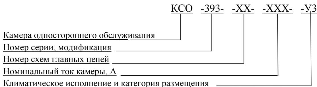
Пример записи условного обозначения камеры КСО при их заказе и в другой документации камера КСО-393-8ВВ-600-УЗ – камера одностороннего обслуживания серии 393, 3 – типоразмера, схема главных цепей 8ВВ-600, камера на номинальный ток 630А, климатического исполнения УЗ, выполненная по ТУ 3414 - 002 - 91862003 – 2013.
